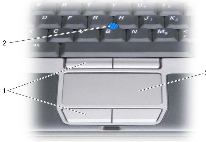
1 أزرار لوحة اللمس/أزرار عصا التوجيه      2 عصا التوجيه      3 لوحة اللمس
