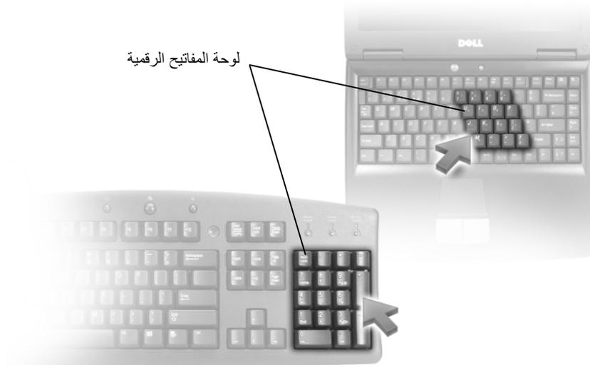
تعمل لوحة المفاتيح الرقمية مثل لوحة المفاتيح الرقمية الموجودة على أية لوحة مفاتيح خارجية. لكل مفتاح على لوحة المفاتيح وظائف متعددة. يتم تمييز أرقام ورموز لوحة المفاتيح باللون الأزرق على يمين مفاتيح لوحة المفاتيح. لكتابة رقم أو رمز، اضغط لأسفل على <Fn> واضغط على المفتاح المطلوب.
